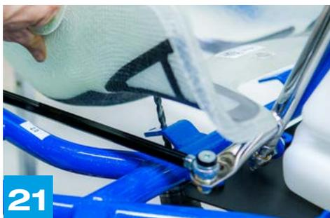
21 Rimuovere la vite di fissaggio al piano provvisorio per rimuovere il piano di appoggio in legno
