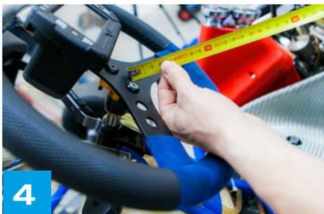
**4** Misurazione dall'asse volante al bordo superiore dello schienale del sedile standard
