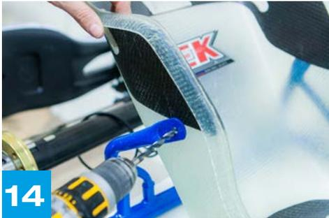
14 Forare lateralmente il sedile in corrispondenza del telaio dx
