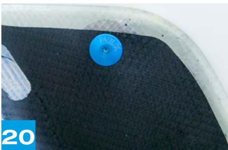
20 Vincolare il sedile Nek tramite le vite Nek al telaio e ai supporti mobili
