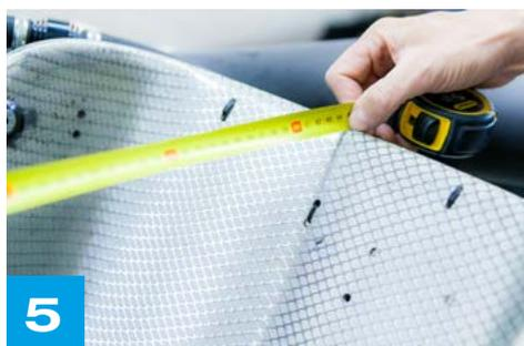
**5** Misurazione della parte superiore del sedile standard dall'asse del volante
